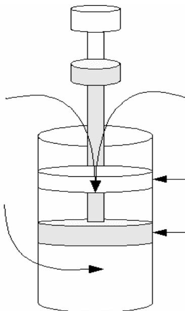
qui est identique à la pression intérieure donc dans le cas où le piston bouge la pression extérieure qui est constante est toujours égale à la pression intérieure donc la différence d'énergie cinétique ou de température est directement convertie en différence de volume, la masse sur l'axe du piston peut être vue comme la force nécessaire pour faire tourner une génératrice ou dynamo
