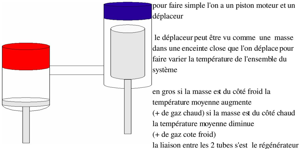
$V_t$  = volume total,  $V_1$  volume du régénérateur + déplaceur,  $\Delta v$  volume du piston moteur
